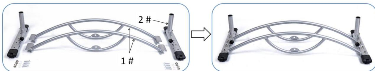
① Поочерёдно разместите две детали главной рамы (1#) на правый и левый стабилизаторы (2#) и закрепите их следующим образом: сначала выполните вертикальный крепёж при помощи болтов (18#), шайб (19#) и гаек (20#), а затем горизонтальный – при помощи болтов (15#), шайб (16#) и гаек (17#). См. рисунок.
