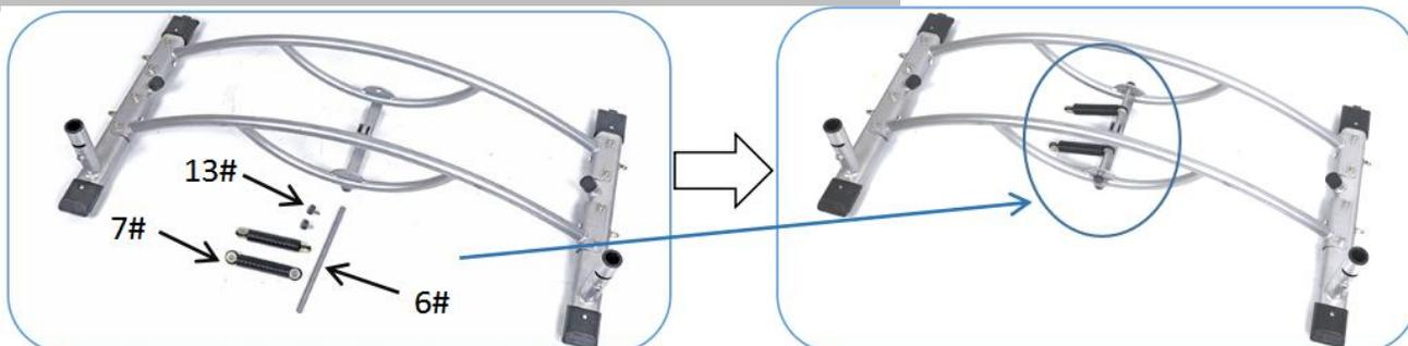
① Установите ось (6#) таким образом, чтобы она прошла через отверстия в главной раме (1#), пружинах (7) и пружинной опоре (5#). См. рисунок.
