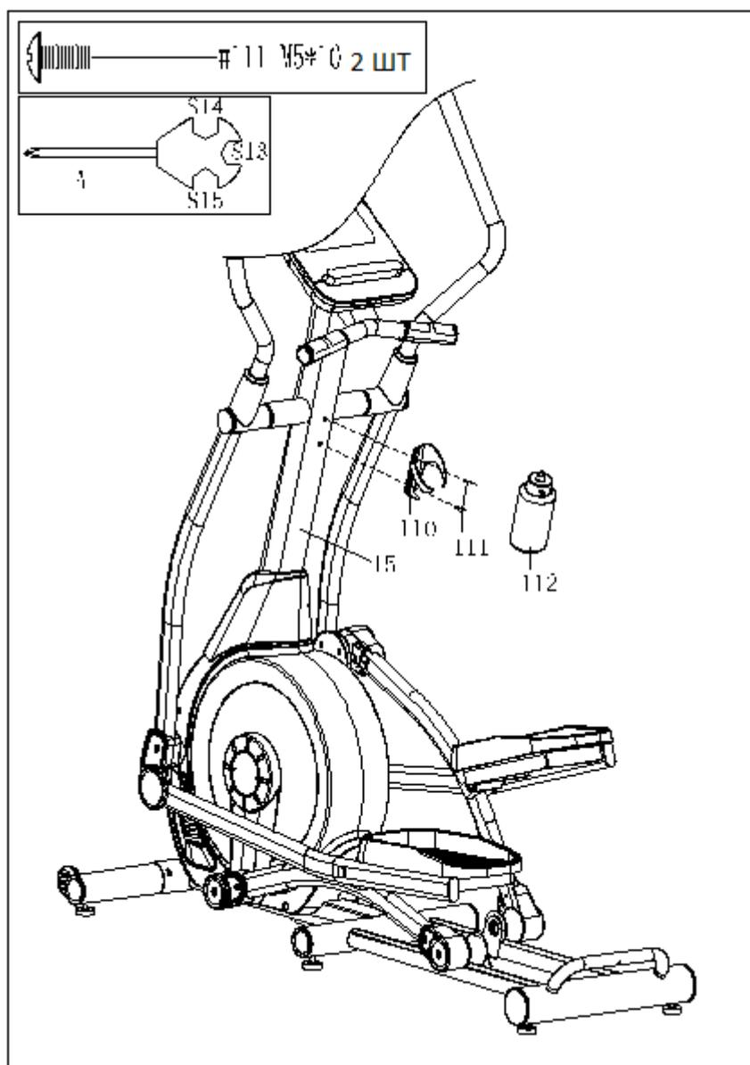
С помощью винтов (111) и вилочного ключа (A) закрепите держатель для бутылки (110) на соединительном поручне (15). Затем поместите бутылку для воды (112) в держатель для бутылки (110).
