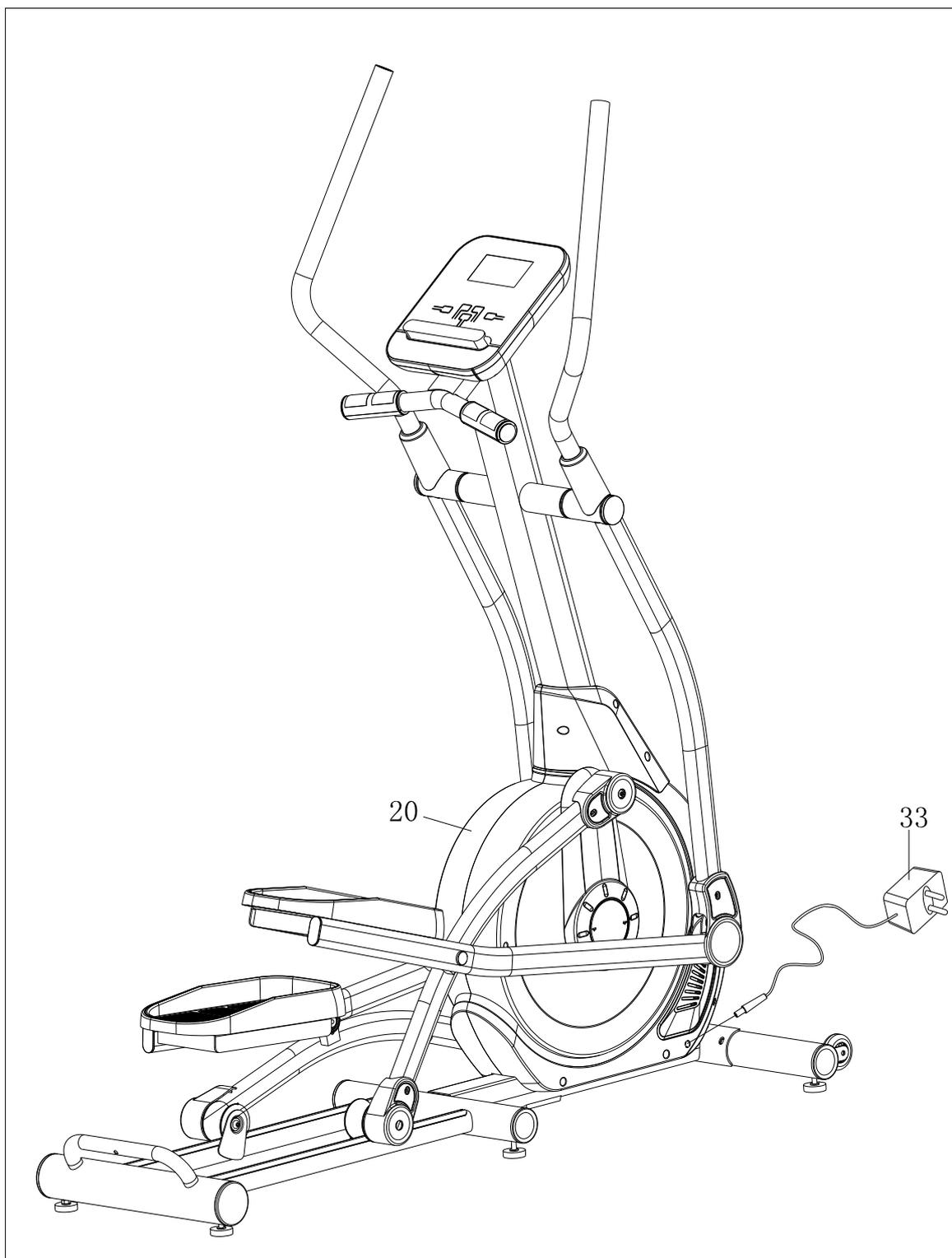
Перед началом тренировки подключите кабель адаптера (33) к разъему питания, расположенный с передней стороны основной рамы (20), после чего подключите сам адаптер (33) к электрической розетке.
