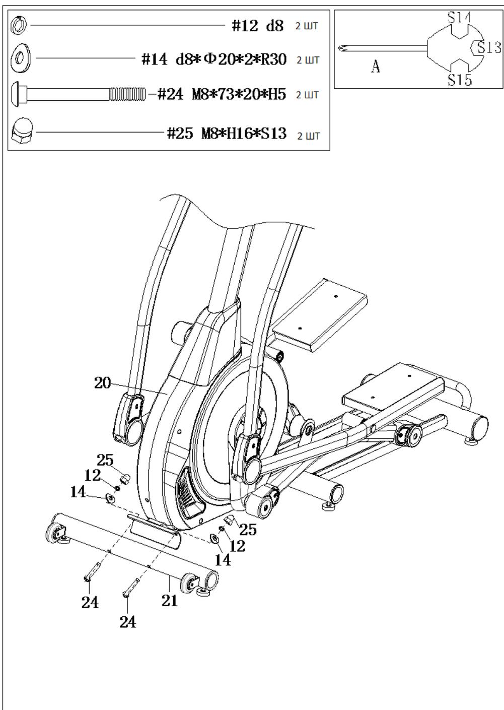
С помощью вилочного ключа (А), а также винтов (24), дуговой шайбы (14), пружинных шайб (12) и гаек (25) прикрепите передний стабилизатор (21) к основной раме (20).
