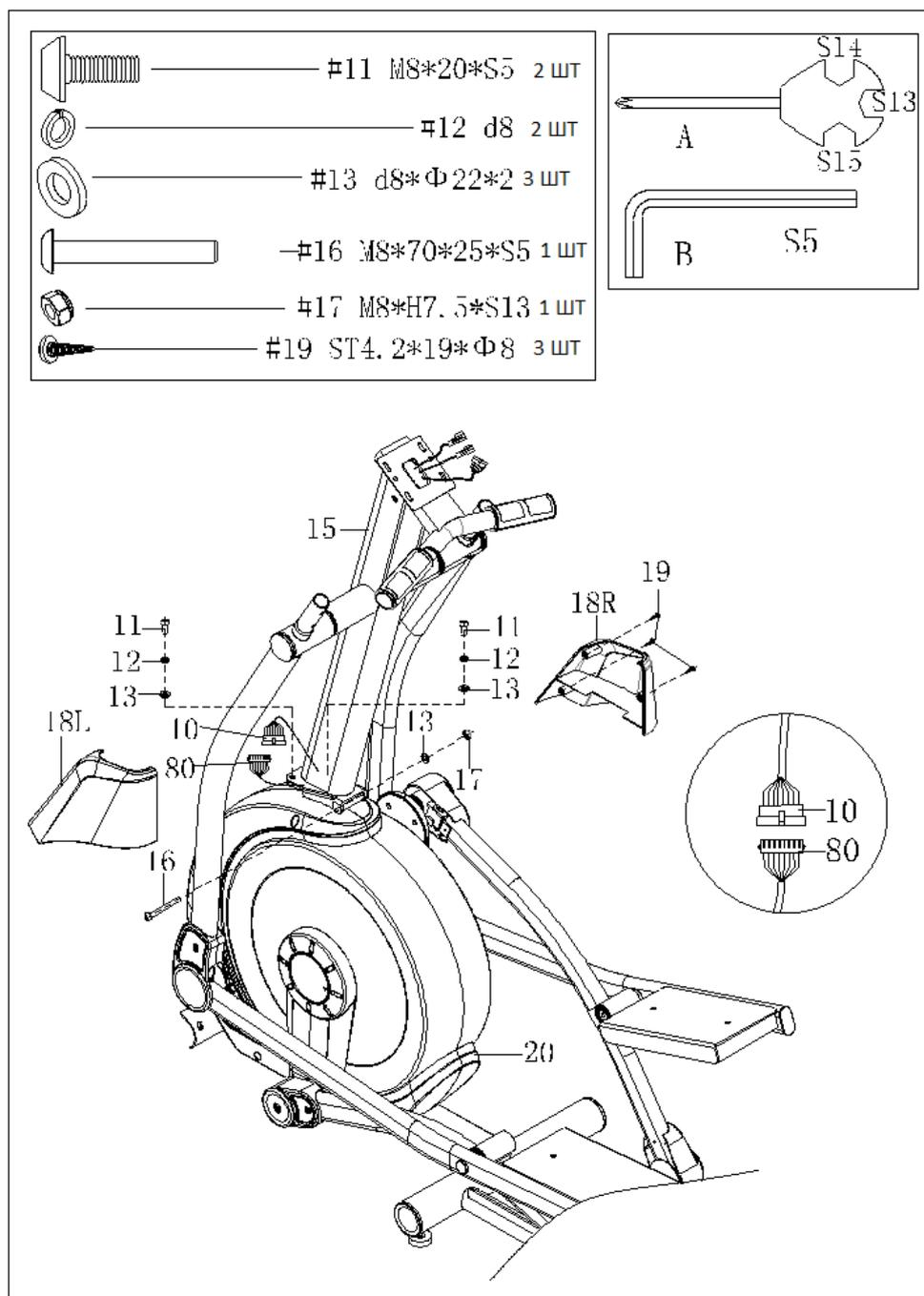
А. Соедините магистральный кабель 1(10) с соединительным поручнем (15) и магистральный кабель 2(80) – с основной рамой (20). Затем подсоедините соединительный поручень (15) к основной раме (20).
